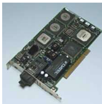
Figura7.81 - Placa SDH SONET 155 Mbits/s.
