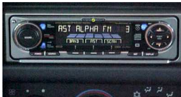
Figura 7.170 - Receptor FM estereofônico para veículos automotores, com sistema RDS incorporado.
