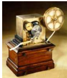
Figura 6.41 – Multiplexor: O avô dos sistemas multiplex (Baudot).
