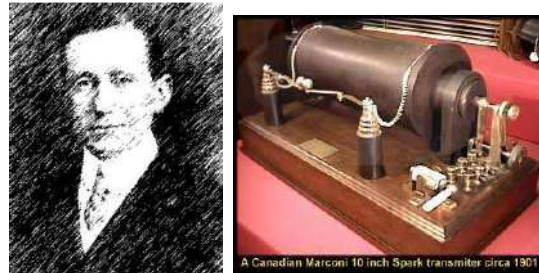
Figura 3.3 – b) Centelhador de Marconi e G. Marconi (1874-1937).
